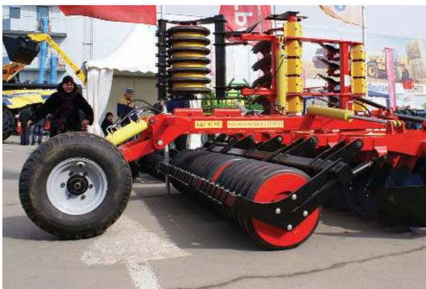
На орудиях БДМ-В основной опцией стоят двухрядные прикатывающие катки. Катки выполнены со смещением второго ряда для перекрытия промежутков между катками. Катки первого ряда большего размера, спиральные –
